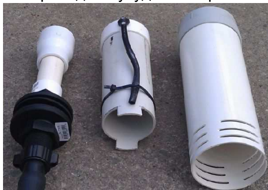
Механический сифон с трубкой инжектором воздуха.
