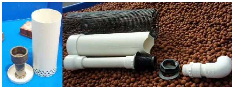
Механические сифоны без трубки инжектора
